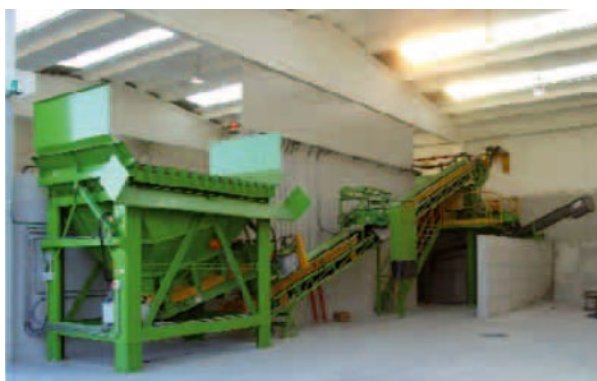
Tramoggia di carico e nastro alimentatore
